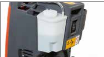
Kivehető tisztítószer tartály kívülről látható töltési szinttel.
