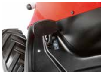
Differenciálzár, ami maximális tapadást biztosít bármilyen talaj és lejtés esetén.
