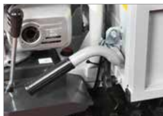
Kézi billentés automatikus reteszelőrendszerrel.
