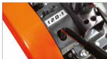
Külső, ergonomikus, könnyen hozzáférhető sebességfokozat-választó.
