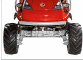
A gép nagyméretű, alacsony súlypontú futófelülete, ami maximális stabilitást biztosít egyenetlen talajon, folyópart és árok közelében.
